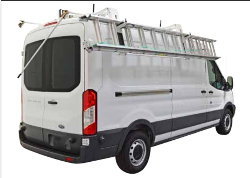
**LEFT IMAGE:** LADDER RACK ON A MID-ROOF VAN IS IN THE DOWN POSITION. NOTE IT IS EASY TO REACH THE DETACHABLE HANDLE WHICH CAN BE STORED INSIDE THE VAN.
